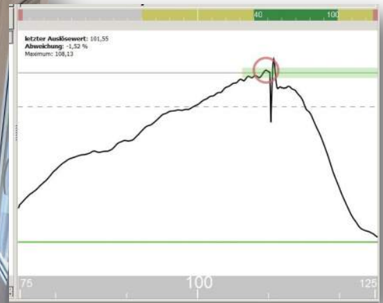
Computer read-out actual applied torque
